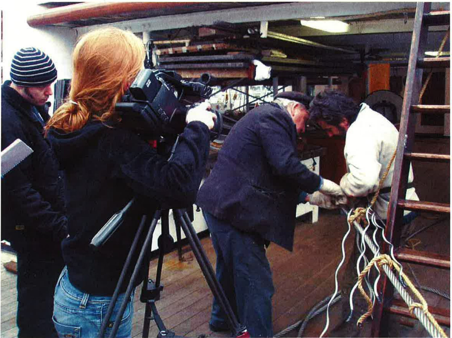
Charles en Philippe maken de strengen van een stalen kabel los, vlechten ze vervolgens opnieuw in en brengen een beschermende takeling aan. Onze cameravrouw zet alles op film vast.
